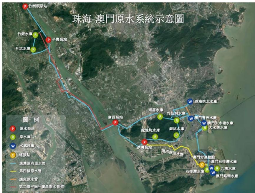
圖中紅色標籤標示與澳門原水供應相關的 4 個主要原水加壓泵站，其中竹洲頭、平崗以及廣昌為主要取水口。澳門約 95% 或以上的原水來自西江。自 2006 年開始，為應對鹹潮情況，位於珠海磨刀門的取水口位置已往上游遷移超過 20 公里，延伸至平崗泵站，並於 2011 年延伸到竹洲頭泵站。
